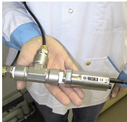
Das kompakte DMT152 misst Taupunkte bis -80 °C.
