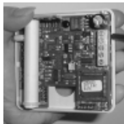
Emolevyn irrottaminen ja paikoilleen asentaminen
