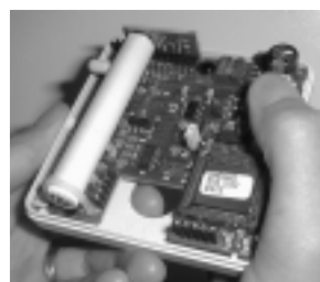
Emolevyn irrottaminen ja paikoilleen asentaminen
